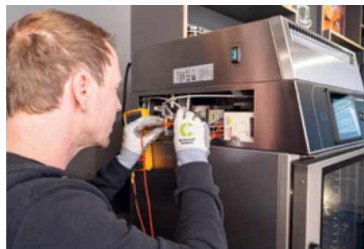
Ułatwiająca serwis konstrukcja Convotherm mini z czterema portami serwisowymi ułatwia konserwację i naprawy, sprawia że są one szybsze i mniej kosztowne.
