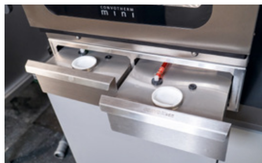
Kompaktowa szuflada na środek czyszczący do napełnienia środkiem płuczącym ConvoCare i środkiem czyszczącym ConvoClean.
